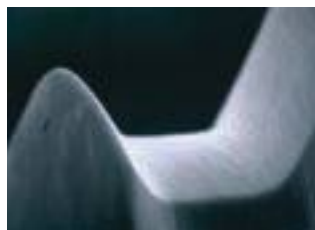
Оптимизированная поверхность бесстружечного метчика
